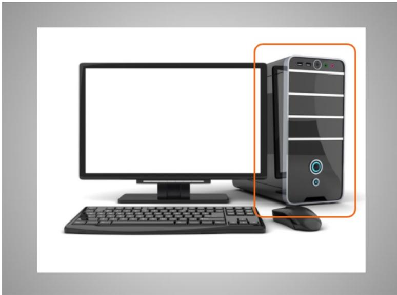
Una computadora de escritorio tiene diferentes partes. El gabinete de la computadora es el que contiene las partes principales de la computadora que la hacen funcionar y procesar la información. En este ejemplo, el gabinete es una caja separada.
