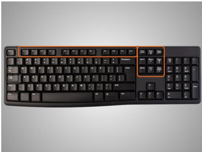
En la parte superior del teclado se encuentran las teclas de función y las teclas especiales, las cuales tienen usos específicos.
