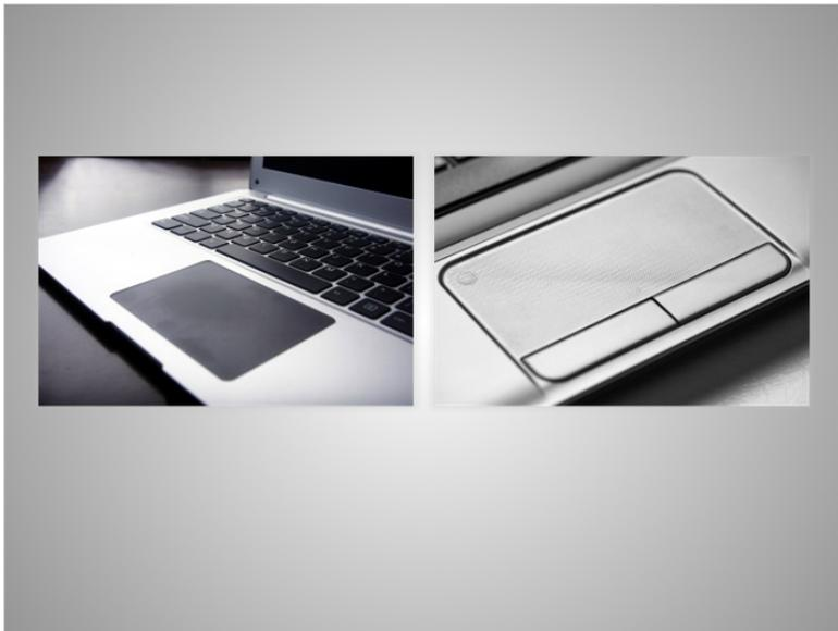
Un panel de seguimiento o panel táctil también permite mover el puntero e interactuar con la computadora. Este es común en computadoras portátiles y responde al tacto de los dedos para mover el puntero. Algunos paneles táctiles le permiten hacer clic en cualquier lado de ellos, en lugar de presionar un botón como lo hace con un ratón.
