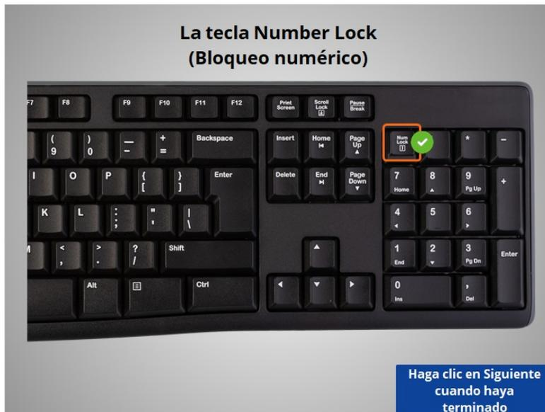
La tecla Number Lock (Bloqueo numérico): algunos teclados tienen un teclado numérico al costado y, si activa el bloqueo numérico, el teclado numérico funcionará con los números. Si el bloqueo numérico no está activado, el teclado numérico se convierte en un teclado de navegación como las teclas de dirección.
