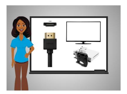
El puerto HDMI envía y recibe audio y video de alta definición desde un dispositivo, como una computadora, a otros dispositivos, como un televisor, un proyector, una consola de juegos o un dispositivo móvil.
